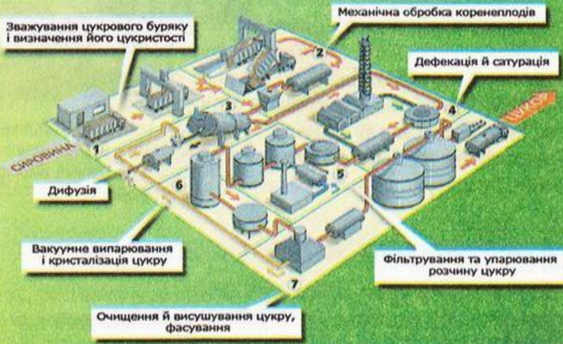
Мал. 32.5. Загальна схема виробництва цукру
