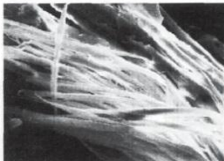
Рис. 4.8. Микрофотографии мериносового шерстяного волокна: 1 — исходное неповрежденное волокно ( \times 3000 ); 2, 3 — бактериальные клетки на поверхности волокна ( \times 3000 ); 4 — фибриллизация волокна после воздействия микроорганизмов в течение 4 нед. ( \times 1000 )
