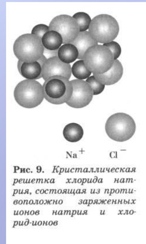
Рис. 9. Кристаллическая решетка хлорида натрия, состоящая из противоположно заряженных ионов натрия и хлорид-ионов
