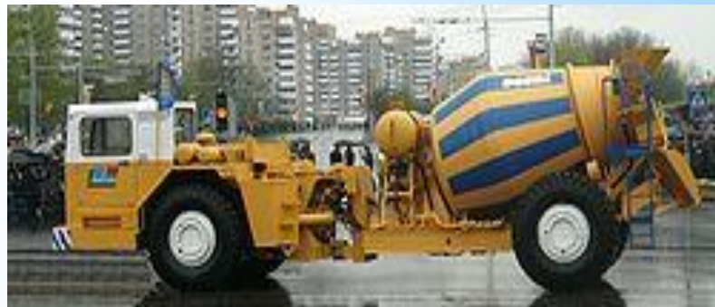
Растворосмеситель для подземных бетонных работ
