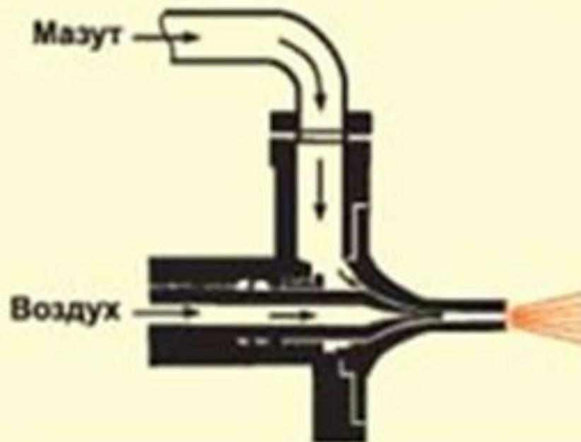
**Схема действия форсунки
