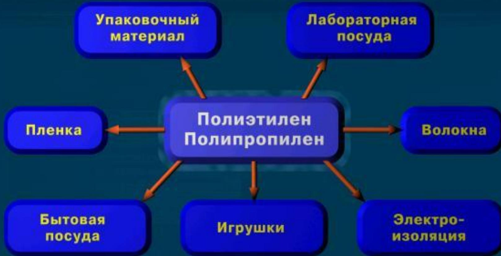
Полипропилен, также как и полиэтилен, имеет широчайшее применение. Из него производят пленку, упаковочный материал, пробки, мешки, емкости, трубы, предметы домашнего и технического обихода, лабораторную посуду, игрушки, электроизоляцию, волокно. Из полипропиленового волокна изготавливают ткани, похожие на шерсть, шелк, хлопок или лен (в зависимости от выделки ткани), сети, канаты и т.д.
