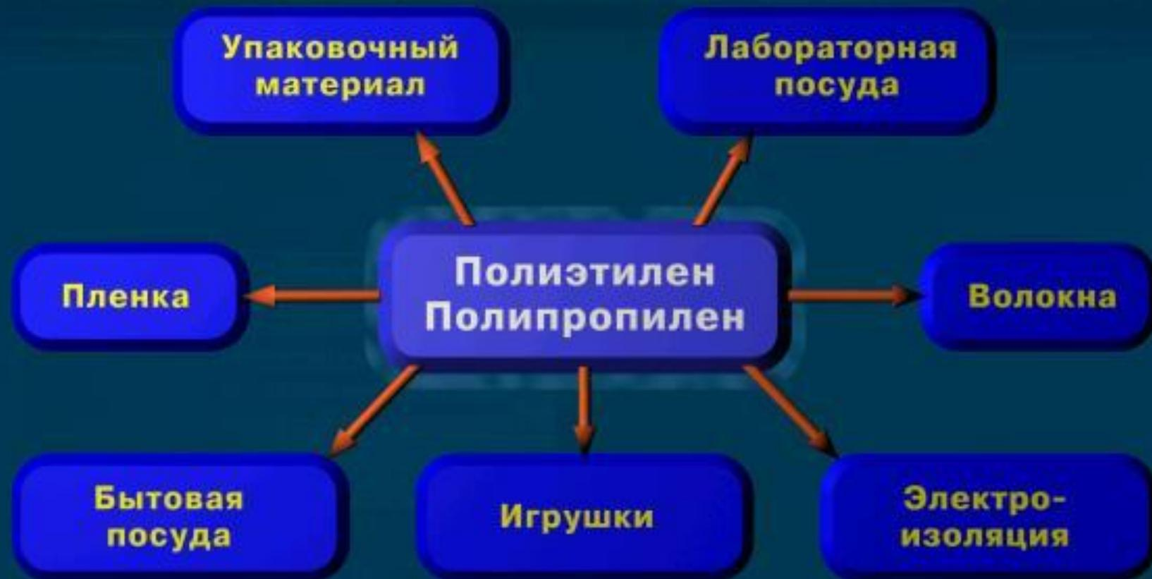
Полипропилен, также как и полиэтилен, имеет широчайшее применение. Из него производят пленку, упаковочный материал, пробки, мешки, емкости, трубы, предметы домашнего и технического обихода, лабораторную посуду, игрушки, электроизоляцию, волокно. Из полипропиленового волокна изготавливают ткани, похожие на шерсть, шелк, хлопок или лен (в зависимости от выделки ткани), сети, канаты и т.д.
