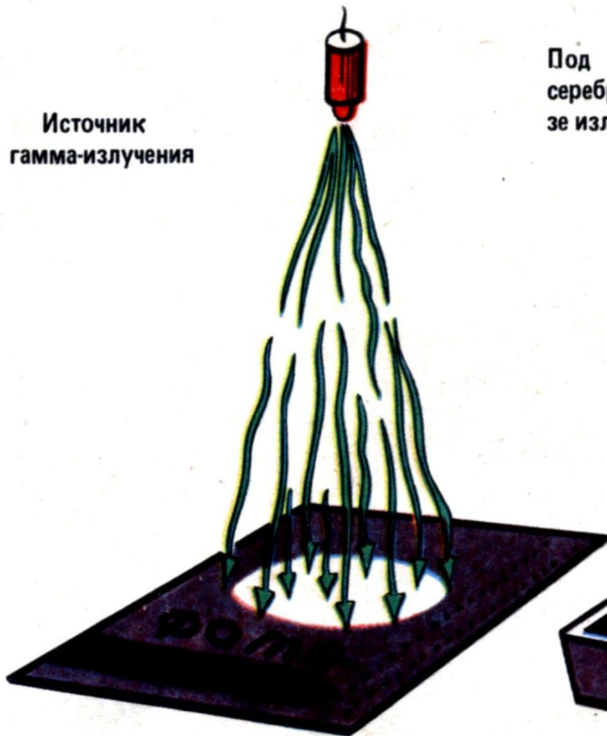
Под воздействием ионизирующих излучений бромистое серебро фотозмульсии распадается на серебро и бром. О дозе излучения судят по степени потемнения пленки.
