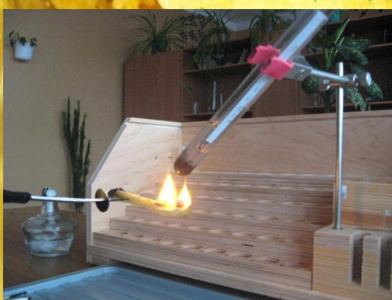
Для определения калорийности продуктов мы воспользовались формулой  $Q = (C(\text{воды}) \cdot t(\text{воды}) + C(\text{стекла}) \cdot (\text{стекла})) (t - t_0)$ . Проведя расчёты, мы пришли к выводу, что калорийность заявленная производителем на пачках не соответствует нашим расчётам. Так на чипсах марки «Lays» была указана калорийность 520 ккал на 100г продукта. По нашим данным калорийность 100г чипсов «Lays» 996 ккал.
