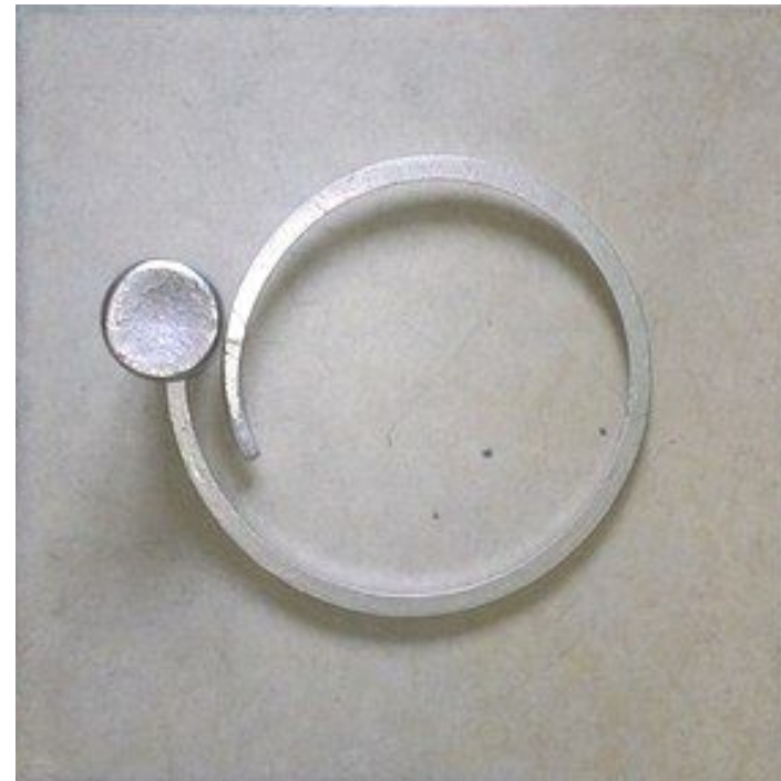
Образец технологической пробы после извлечения из формы
