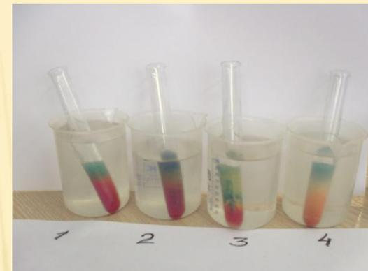
**Ход работы:** Четыре различных фруктовых соков наливаем в восемь пробирок. Контрольная группа – 4 пробирки. Экспериментальная группа – 4 пробирки. Приливаем к экспериментальной группе  $\text{CuSO}_4$  и  $\text{NaOH}$ . Ставим эту группу на водяную баню. Сравниваем две группы.
