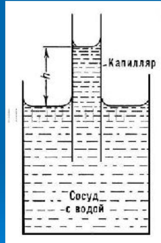
Капилляр в смачивающей (а) и не смачивающей (б) жидкостях
