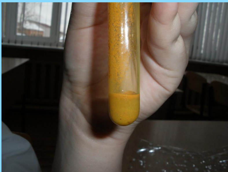
Пробирка №1. Положительная реакция Троммера.
