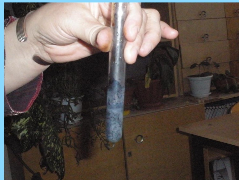
Пробирка №2. Положительная йодокрахмальная реакция.
