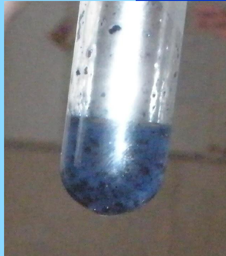
Пробирка №1.1. Положительная йодокрахмальная реакция
