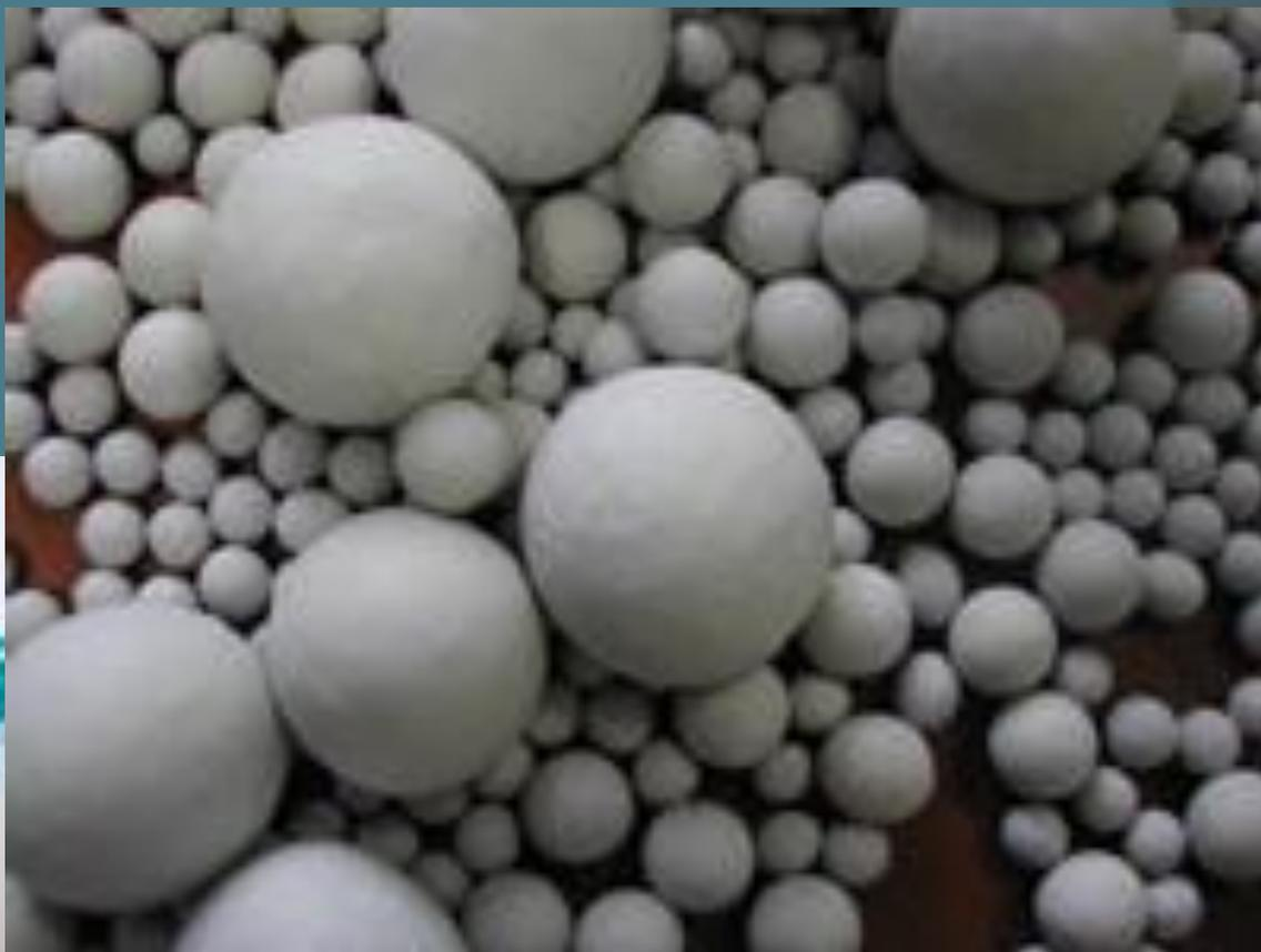
**Катализаторы гидродеароматизации** дизельного топлива были испытаны в лабораторных и полупромышленных условиях, Испытания проводили с использованием в качестве сырья прямогонного дистиллята с 36 % серы и 1.7 % ароматических соединений.
