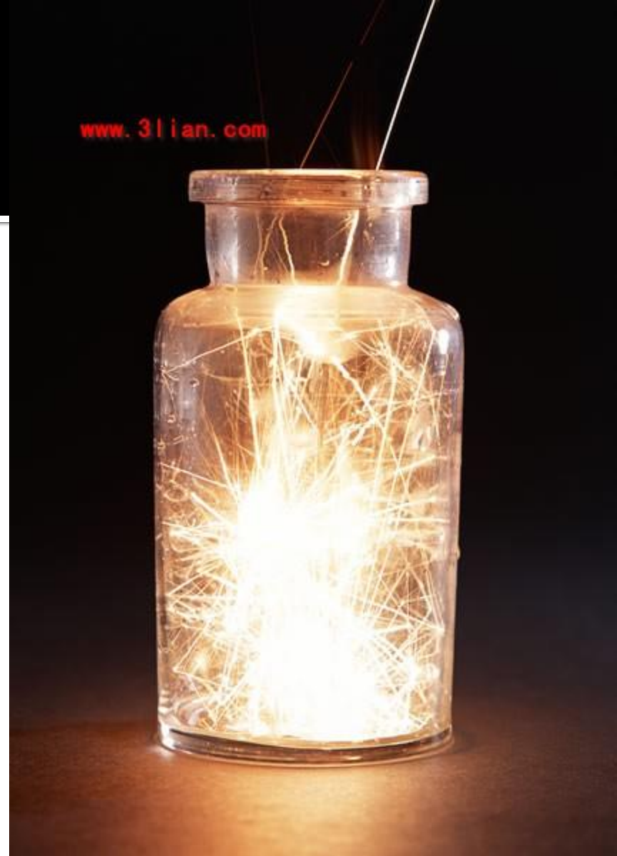
Горение стальной проволоки в кислороде.
