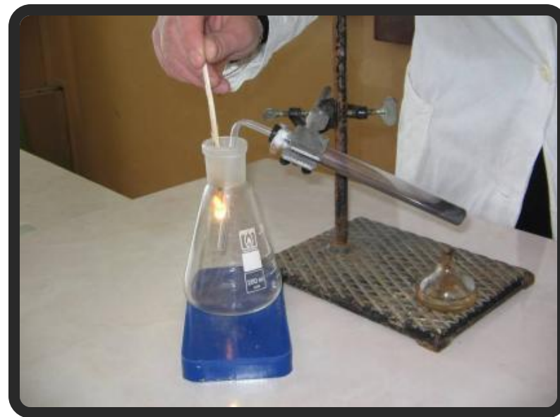
Проверка собранного кислорода
