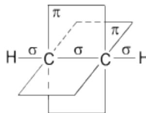
Схематическое изображение строения молекулы ацетилена (ядра атомов углерода и водорода на одной прямой, две  $p$ -связи между атомами углерода находятся в двух взаимно перпендикулярных плоскостях)
