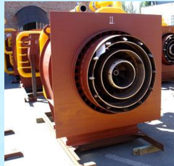
Пылеугольная горелка ООО НТФ "ЭНЕРГОМАШ-инжиниринг" (г. Таганрог)
