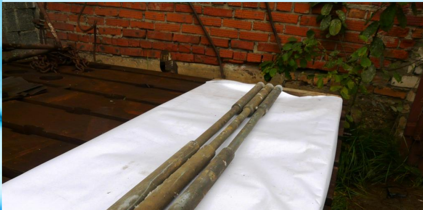
Карборундовые нагреватели. Размер: 26x400мм и 38x400мм, L=1200мм
