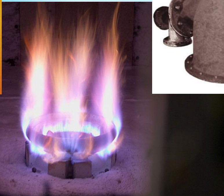
"Горящее гало". Мощная промышленная горелка, работающая в относительно слабом режиме. Chuck Baukal/John Zink Company
