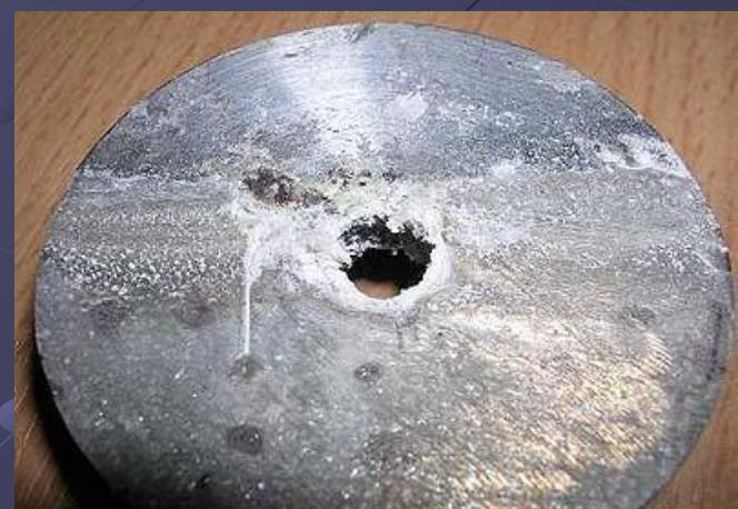
Продукты коррозии могут образовывать на поверхности металла плотный защитный слой, затормаживающий её дальнейшее развитие, или же пористый слой, не защищающий поверхность от разрушающего воздействия среды. В этом случае процесс коррозии продолжается до полного разрушения материала или период времени пока будет действовать агрессивная среда.
