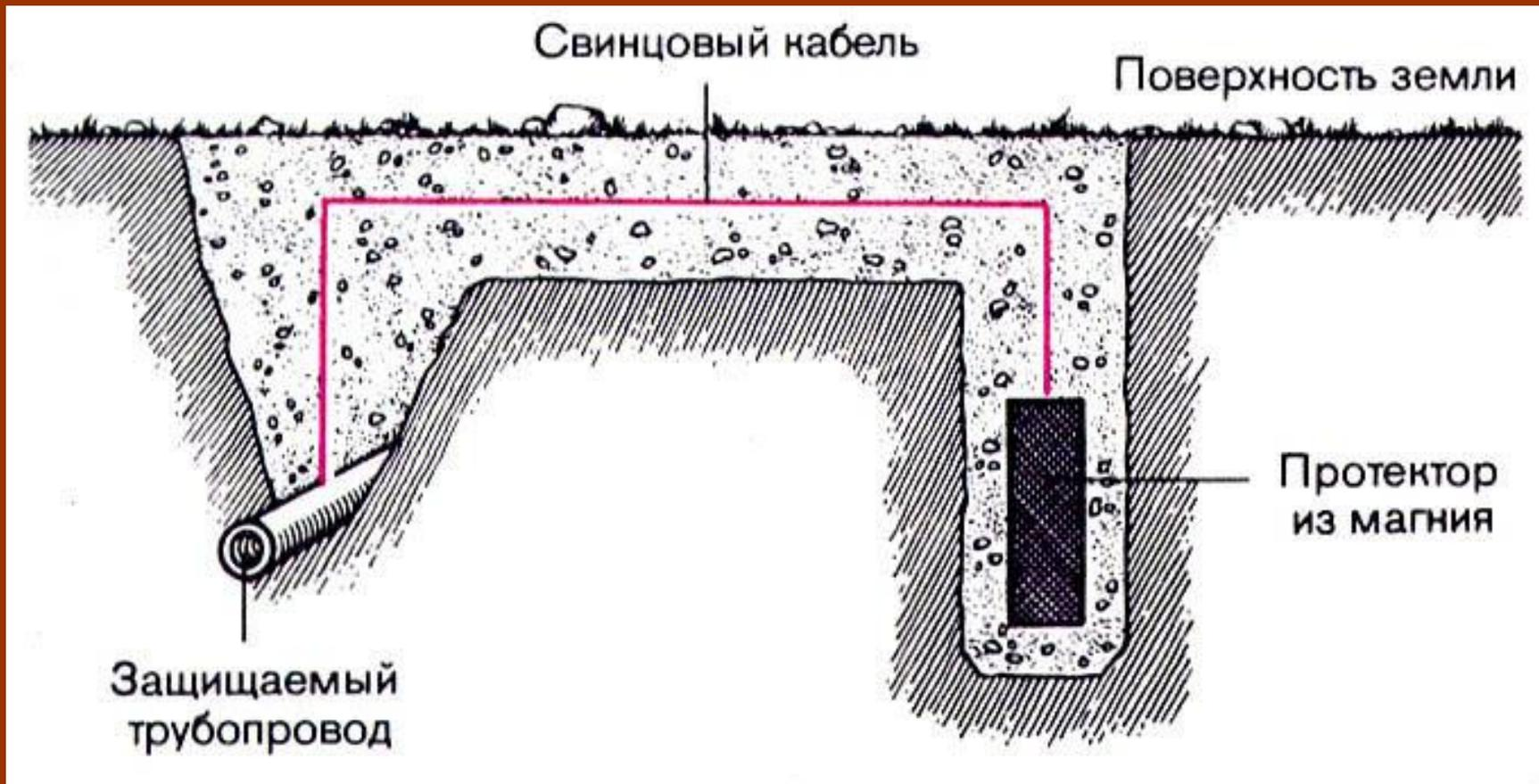
**Протекторная защита** основана на присоединении к защищаемой металлической конструкции листов (протекторов) из более активного металла. Протектор разрушается, предохраняя защищаемый металл.
