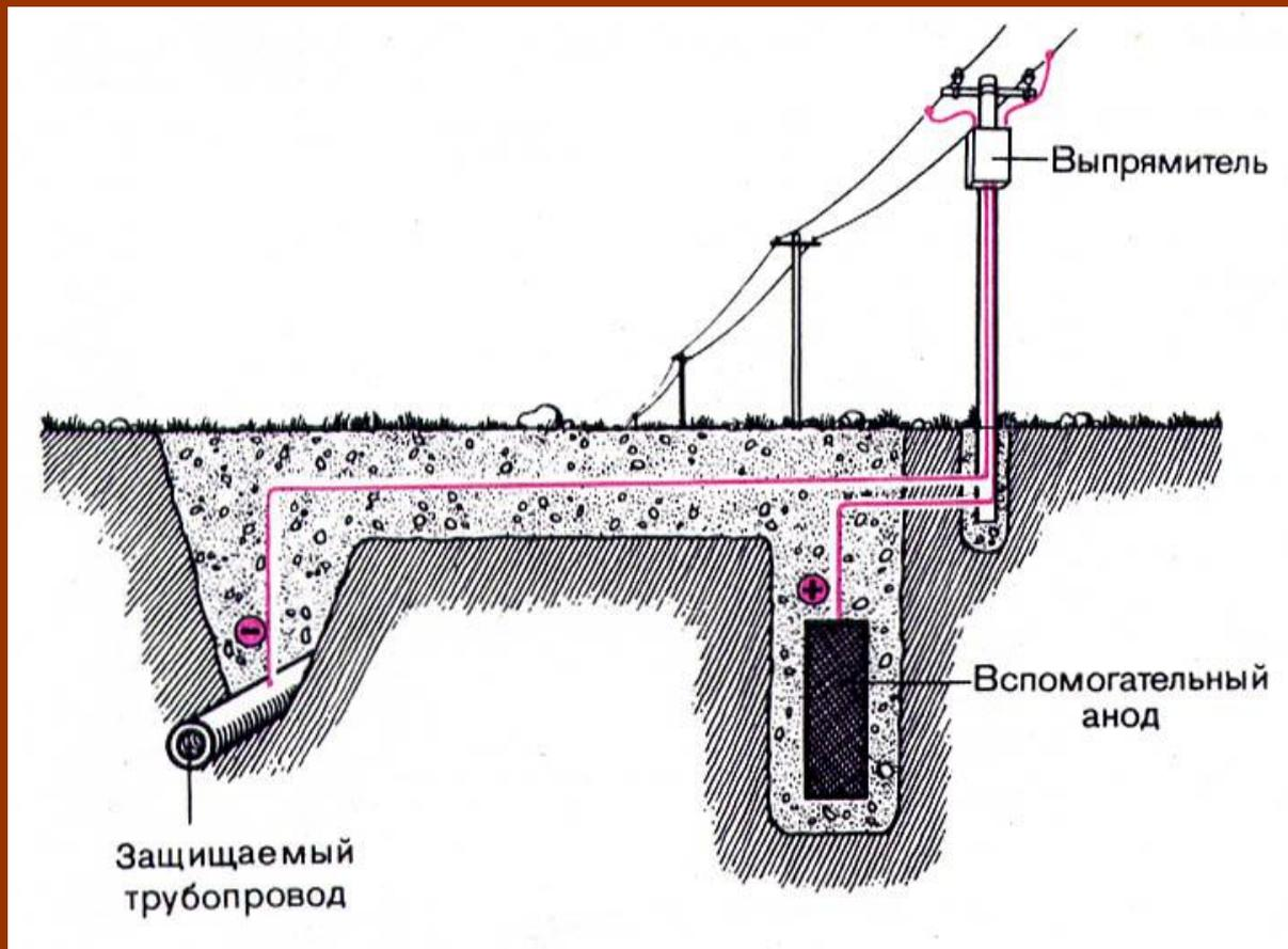
**Катодная защита** основана на присоединении защищаемой металлической конструкции к отрицательному полюсу (катоде) внешнего источника постоянного электрического тока к положительному полюсу подключают анод, изготовленный из железа или графита.
