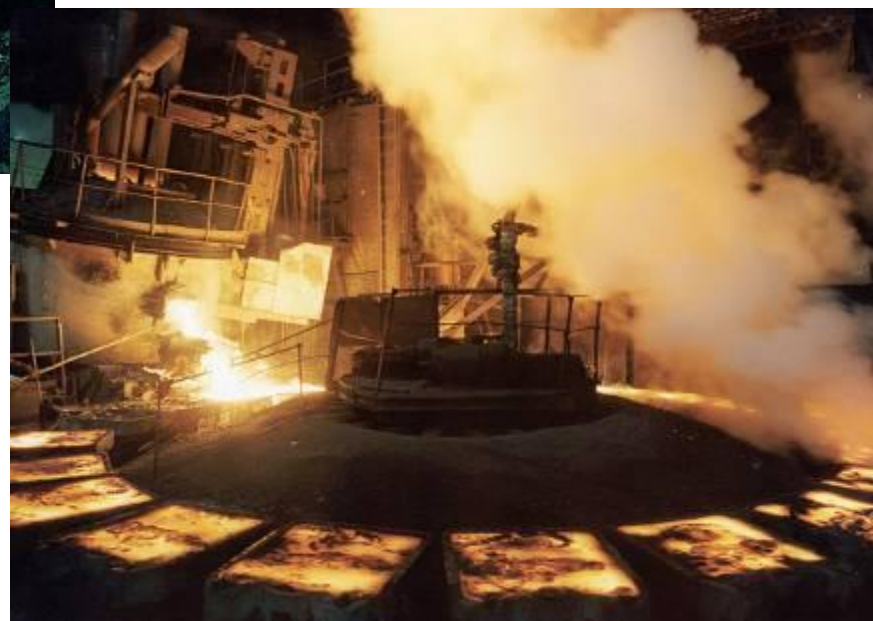
Никелевый завод. Разлив никелевых анодов.
