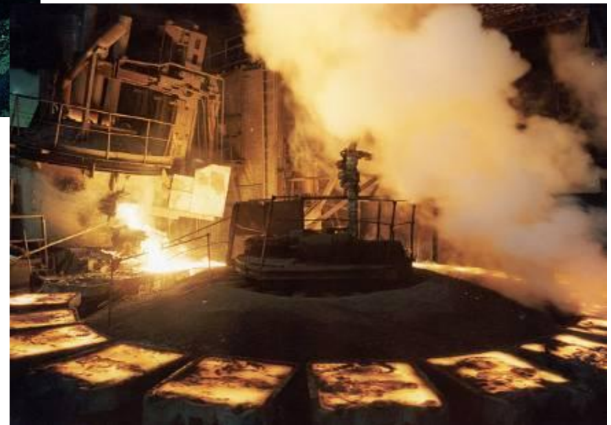
Никелевый завод. Разлив никелевых анодов.
