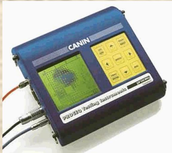
CANIN впервые позволяет производить оценку состояния бетонных конструкций большой площади при непосредственном представлении информации на дисплее индикаторного блока.
