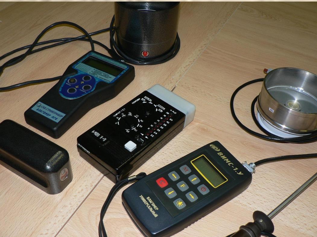
Прибор МГ4 предназначен для оперативного неразрушающего контроля влажности непосредственно на месте отбора проб или в лабораторных (стационарных) условиях диэлькометрическим методом по ГОСТ 21718. Область применения прибора - контроль влажности строительных материалов в процессе производства и при обследовании зданий и сооружений.
