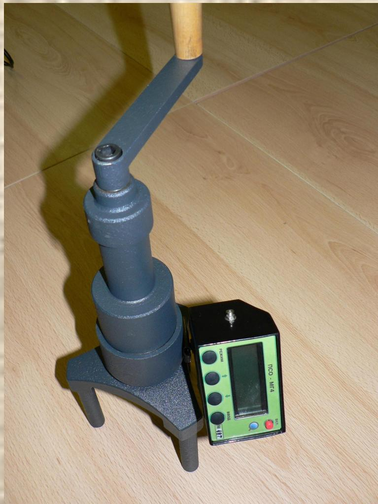
Область применения прибора - определение прочности сцепления облицовочных и защитных покрытий с основанием и усилия вырыв а анкерных болтов и тарельчатых дюбелей на объектах строительства, предприятиях стройиндустрии, в мебельном, деревообрабатывающем и лакокрасочном производстве, при обследовании и реконструкции зданий и сооружений.
