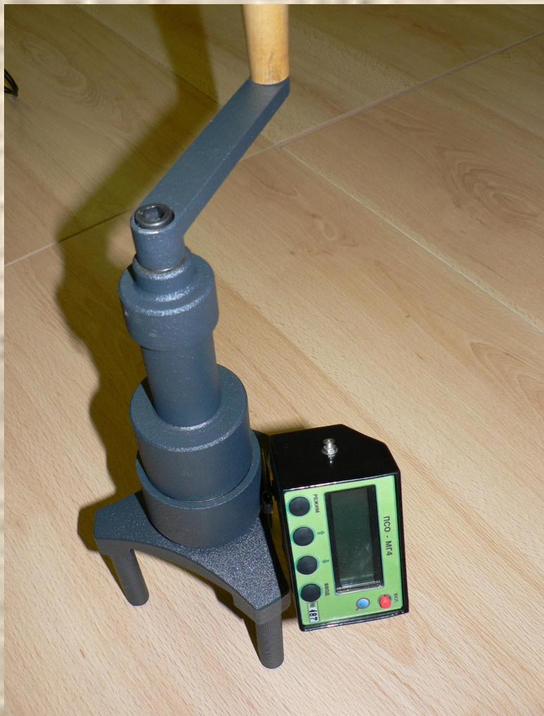
Область применения прибора - определение прочности сцепления облицовочных и защитных покрытий с основанием и усилия вырыв а анкерных болтов и тарельчатых дюбелей на объектах строительства, предприятиях стройиндустрии, в мебельном, деревообрабатывающем и лакокрасочном производстве, при обследовании и реконструкции зданий и сооружений.
