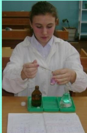
К пробе воды добавляем 3-4 капли раствора фенолфталеина  $C_{20}H_{14}O_4$ .
