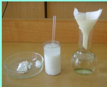
Фото 62. Добавление к морской воде известковой воды  $\text{Ca}(\text{OH})_2$
