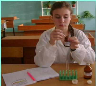
К анализируемой воде добавляем 0.1 г. Сегнетовой соли ( $\text{NaKC}_4\text{H}_4\text{O}_6 \cdot 4\text{H}_2\text{O}$ ) и 1 мл. реактива Несслера.
