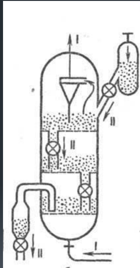
Установка каталитического крекинга
