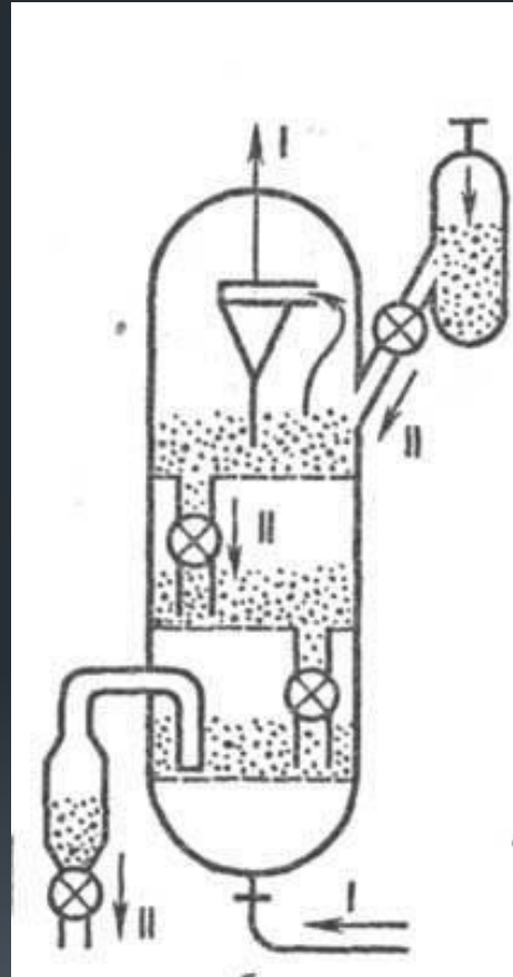
Установка каталитического крекинга
