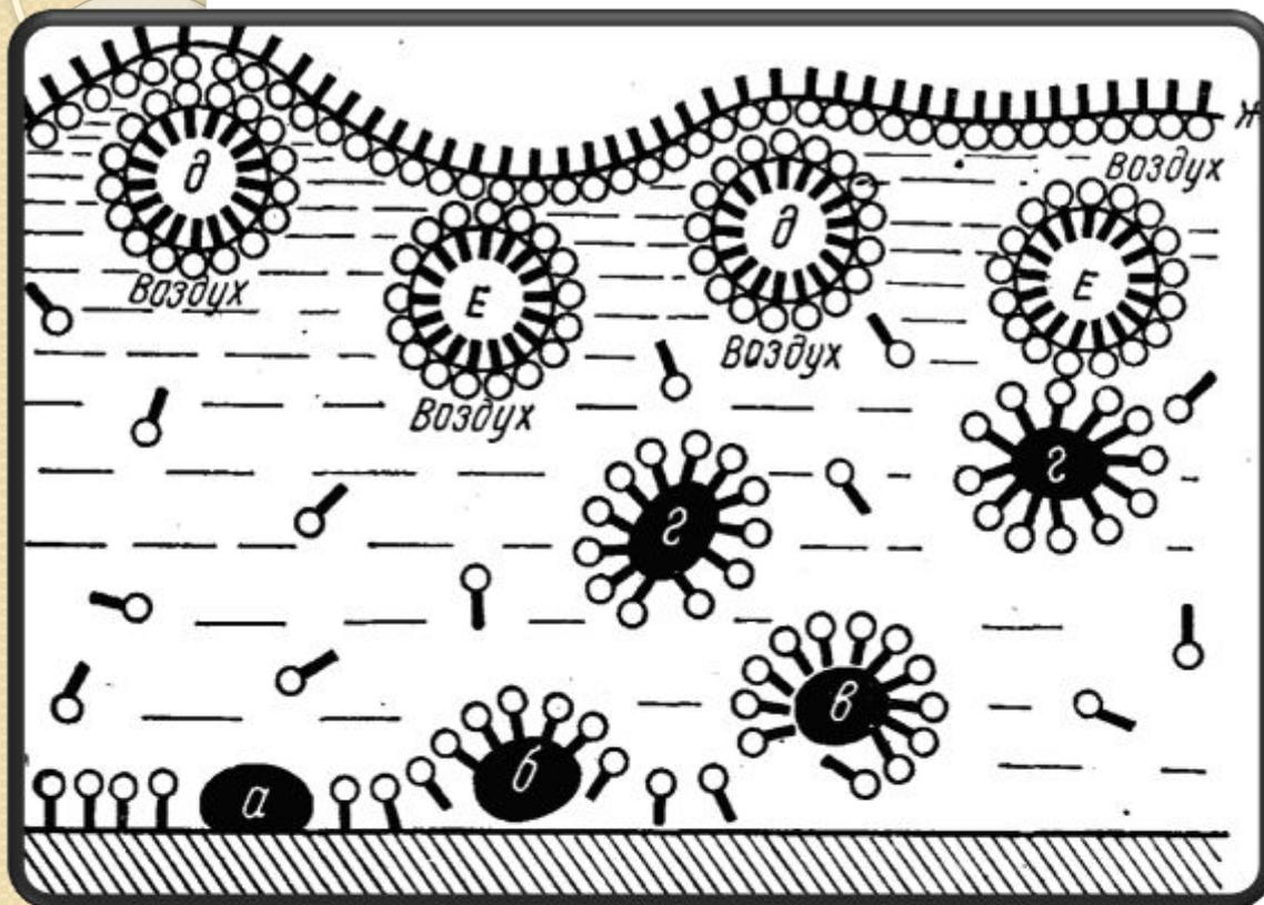
а — грязевая частица на поверхности материала; б — адсорбция моющего вещества на частице грязи; в — отрыв частицы грязи от отмываемой поверхности; г — частица грязи в моющем растворе;
