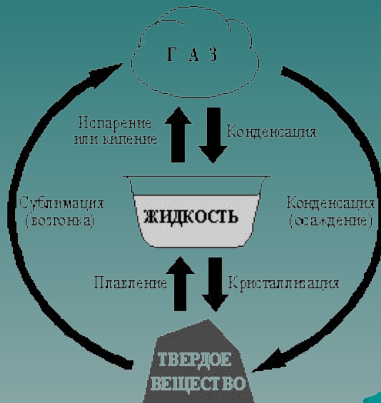
Рис. 1.2. Схема переходов молекулярных веществ из одного агрегатного состояния в другое.
