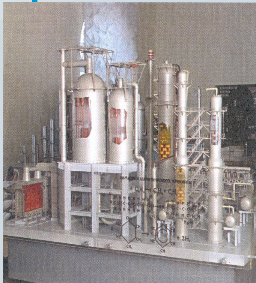
Макет установки для проведения крекинга.
