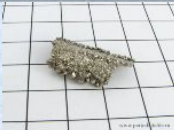
Кристаллы ниобия полученные электролизом
