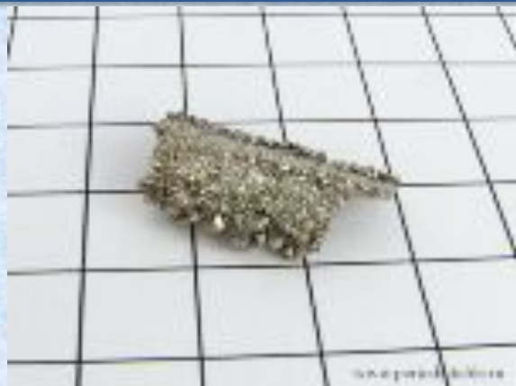
Кристаллы ниобия полученные электролизом
