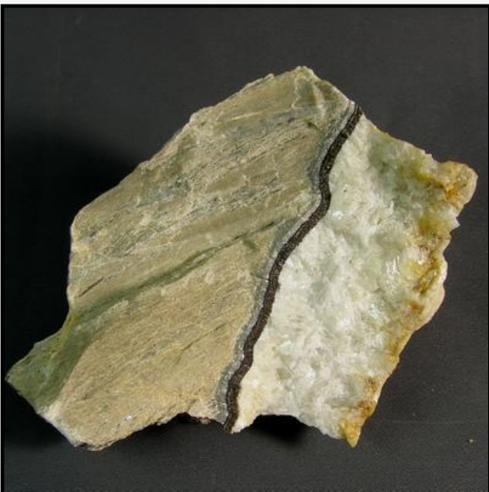
Тонкая (толщ. 2мм) кристаллическая корка самородного мышьяка по контакту доломитового прожилка с вмещающим гнейсом (горная порода).
