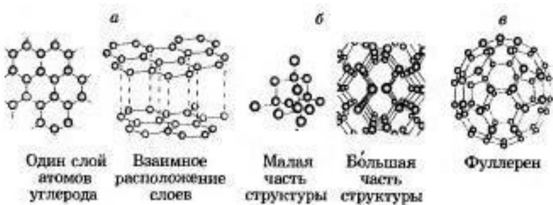
Рис. 48. Кристаллические структуры аллотропных модификаций углерода: а — графит, б — алмаз, в — фуллерен
