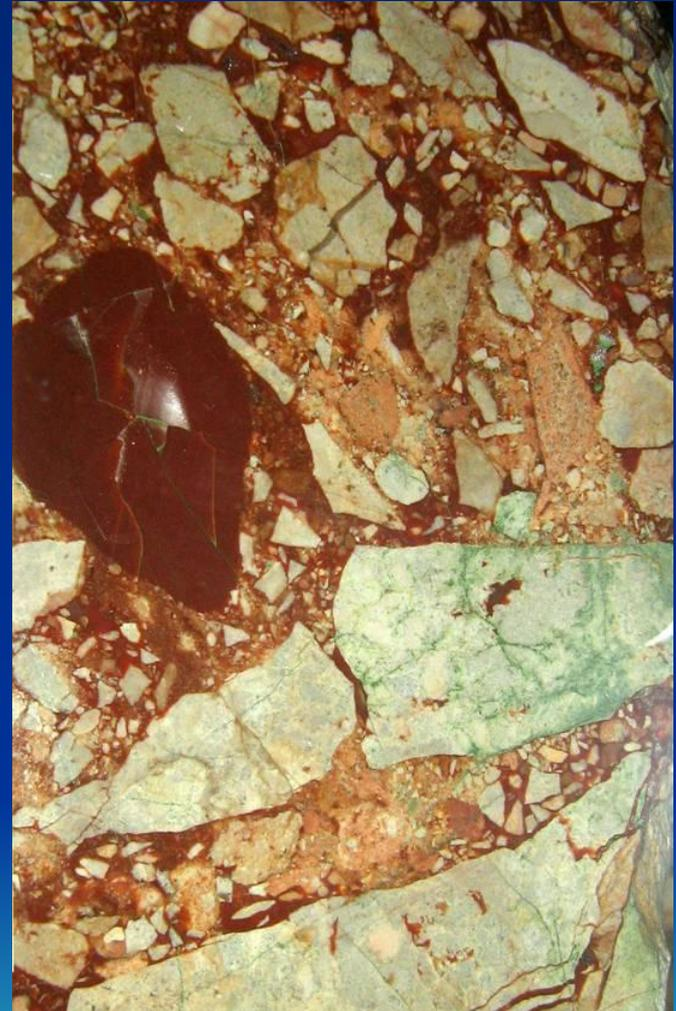
2. **Катаклазит** – состоит из более мелких угловатых обломков, сцементированных тонкоперетертым материалом этой же породы. Текстура – катаклазитовая.
