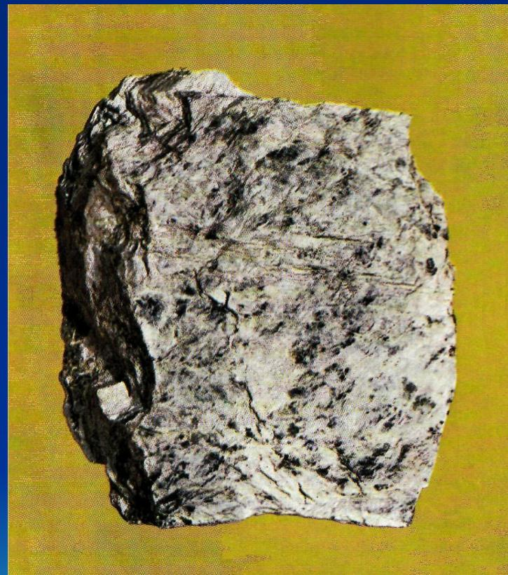
2. **Гнейсы** – породы с очковой или гнейсовой текстурой, внешне часто напоминают граниты, отличаясь от них параллельной ориентировкой слюды. Состоят из полевых шпатов, слюд, кварца, граната.
