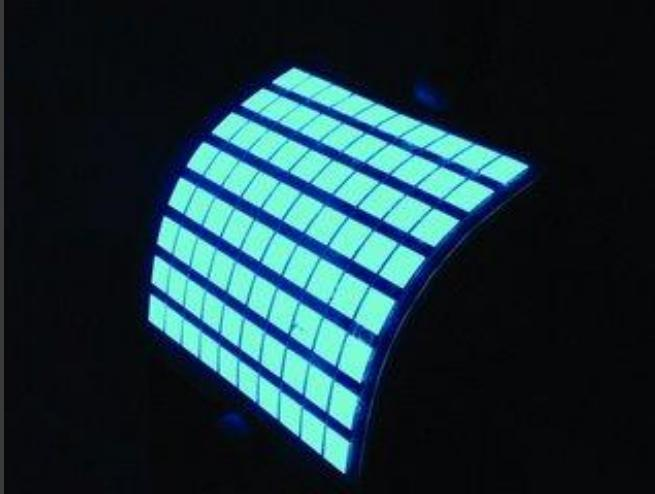
При производстве OLED-дисплеев используются органические молекулы, способные излучать световые волны при подаче электрического напряжения. Выделяют два типа таких молекул. Первый из них – микромолекулы. Их применение отличается высокой стоимостью, связанной с необходимостью применения вакуума при их напылении. Недостатком является и недостаточная гибкость полученного изделия.
