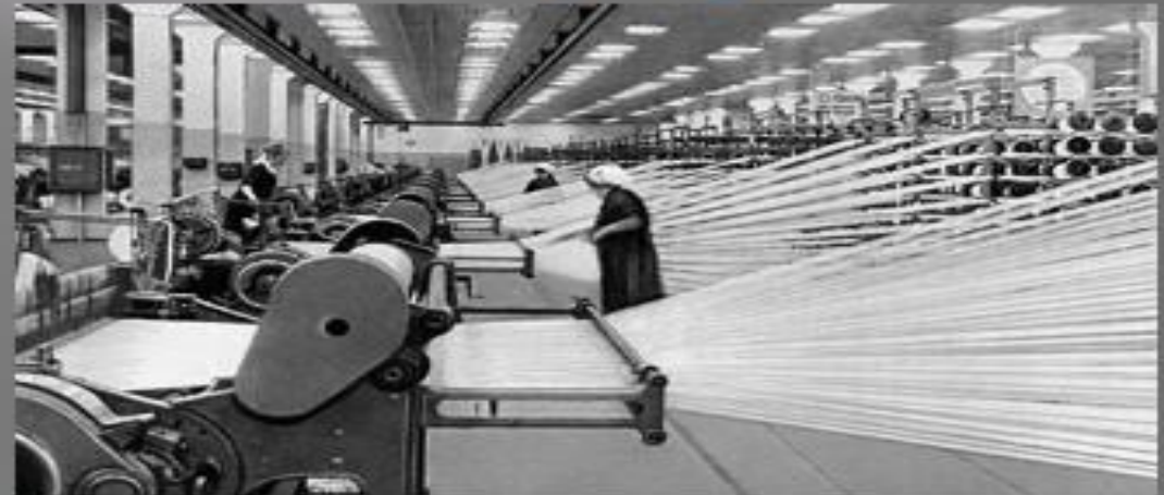
Витягування і термообробка волокна
