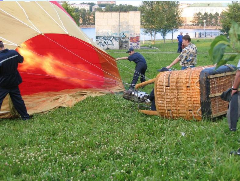
На каркасе корзины крепится газовая горелка, короткие вспышки которой используют для подогрева воздуха при подъеме шара и в полете. Чтобы спуститься вниз, воздухоплаватель должен выпустить немного газа через клапан наверху шара.
