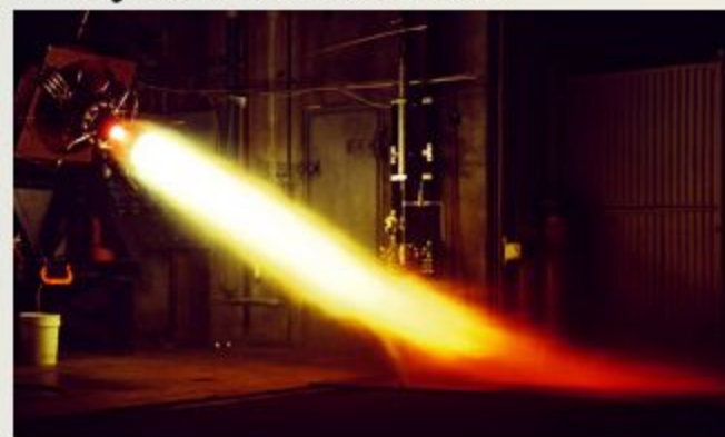
водородное пламя для резки металлов
