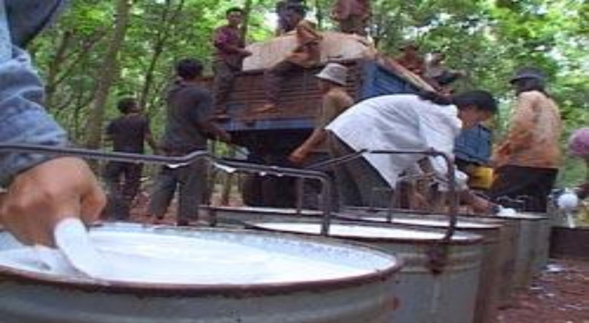
Чтобы жидкость не загустела раньше времени, в нее добавляют **аммиак**. Затем содержимое ведер переливают в цистерну, которую отправят на завод. Там из латекса выделяют собственно каучук. В цистерне установлен фильтр грубой очистки, который задерживает мусор: листья, ветки. С 30-40 ведер его набирается приличное количество.
