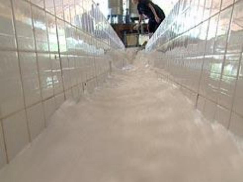
С помощью специального агрегата каучуковую пластины вытягивают из бассейна и по водной дорожке передают на транспортер. Дальше каучук идет по транспортеру и попадает в измельчитель. Здесь пластина измельчается и по трубам подается в специальный контейнер. Рабочие распределяют каучуковую крошку по формам для просушки.
