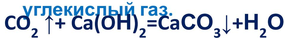
**Наблюдают:** при пропускании углекислого газа через известковую воду известковая вода мутнеет из-за выпавшего в осадок карбоната кальция
