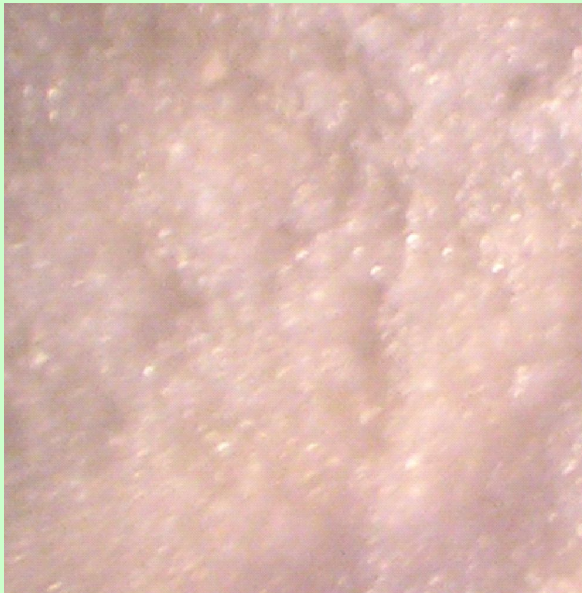
Рис.7. Покрытие \text{Zr}_{0.9}\text{Y}_{0.1}\text{O}_2 на Ni-кермете ( \times 70 )
