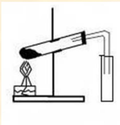
Смесь в пробирке осторожно нагревайте до тех пор, пока в приёмнике – пробирке не собрётся 1 -2 мл жидкости. Прекратите нагревание, закройте спиртовку.
