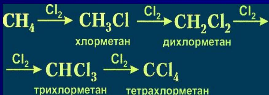
\* Замещение у хлорметана идет легче, чем у метана, так как атом хлора поляризует связи С-Н и делает их реакционноспособными.
