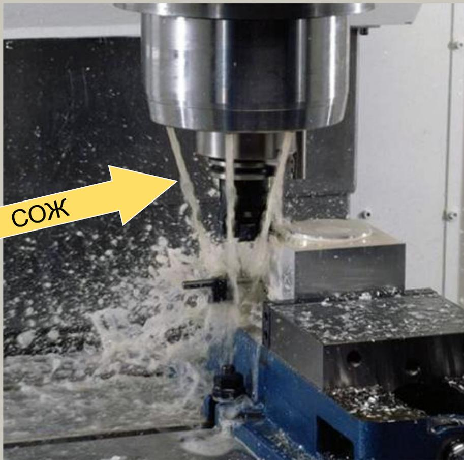
Смазочно - охлаждающие жидкости (СОЖ) применяют для отвода тепла от режущего инструмента. Они снижают температуру в зоне обработки, улучшают качество обработанной поверхности и предохраняют от коррозии режущий инструмент и обрабатываемую заготовку.
