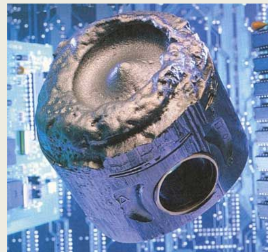
Прогоревший поршень из-за детонации в двигателе
