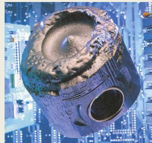
Прогоревший поршень из-за детонации в двигателе
