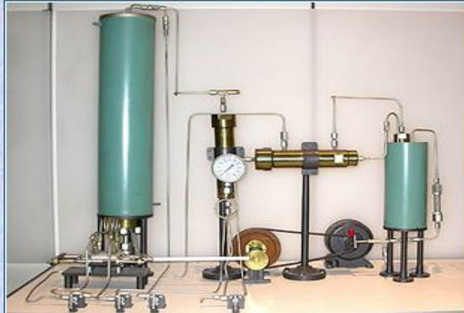
Установка для промышленного производства аммиака, разработанная Ф. Габером и К. Бошем.
