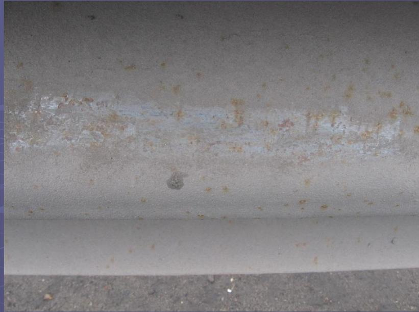
Для защиты чугунных и стальных водяных труб от коррозии используют цементные покрытия. Поскольку коэффициенты теплового расширения портландцемента и стали близки, а стоимость цемента невысокая, то он довольно широко применяется для этих целей. Недостаток портландцементных покрытий тот же, что и эмалевых, – высокая чувствительность к механическим ударам.
