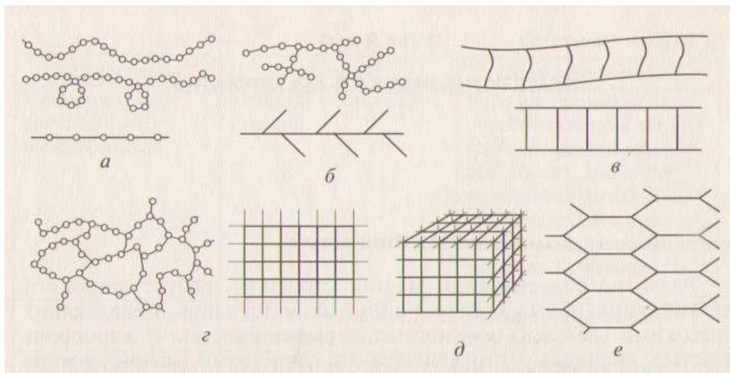
Рисунок 30.1-Формы макромолекул полимеров:
