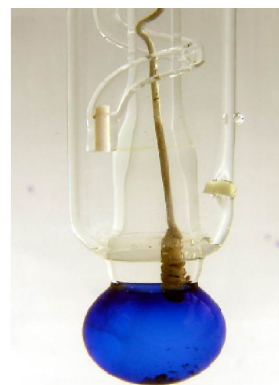
Измерение pH: стеклянный электрод
