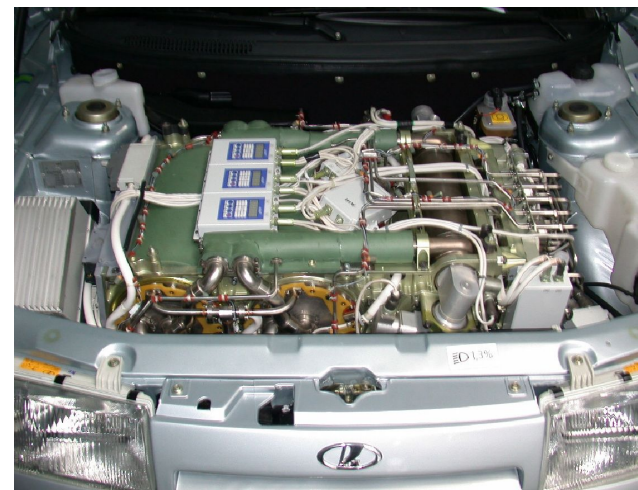
Электромобиль «Антэл-2» с генератором «Фотон МВВ»
