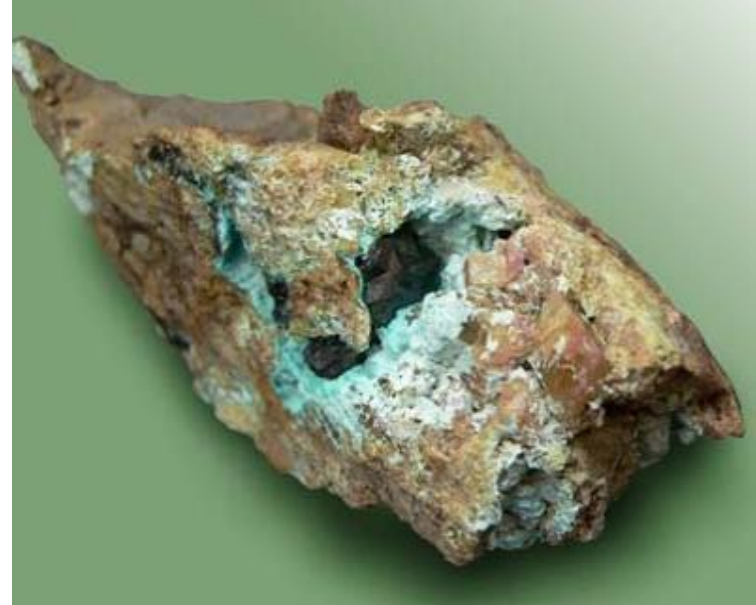
Халькозин - самый богатый медью сульфид \text{Cu}_2\text{S}
