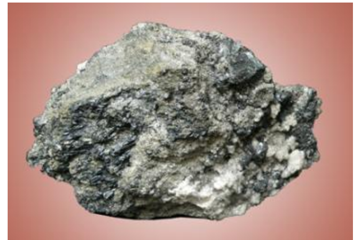
Халькозин - самый богатый медью сульфид \text{Cu}_2\text{S}
