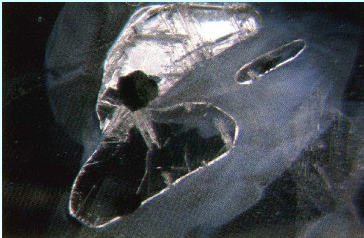
Графит в качестве твердой фазы в многофазных включениях в сапфире Шри Ланки. Размер включений 0,15 мм. ( Gübelin, Koivula, 1996 )
