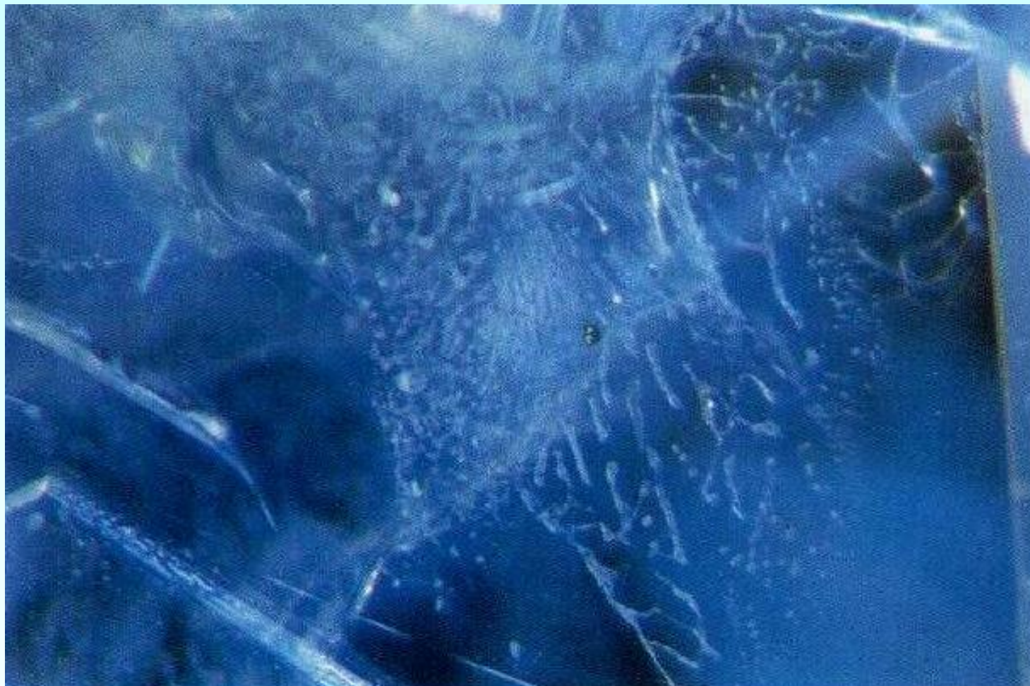
Флюсовые включения в синтетическом сапфире Чатэма. Увел. 40х. ( Gübelin, Koivula, 1996 )
