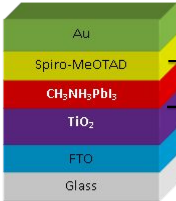
Рис.5. Структура ГОНП ФЭП
